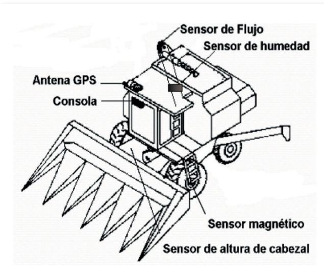
Figura 12 - Componentes del Monitor de cosecha.
