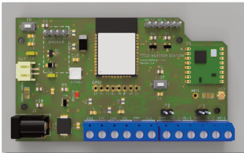
Figura 134 - Modelo 3D de la Estación meteorológica diseñada.
