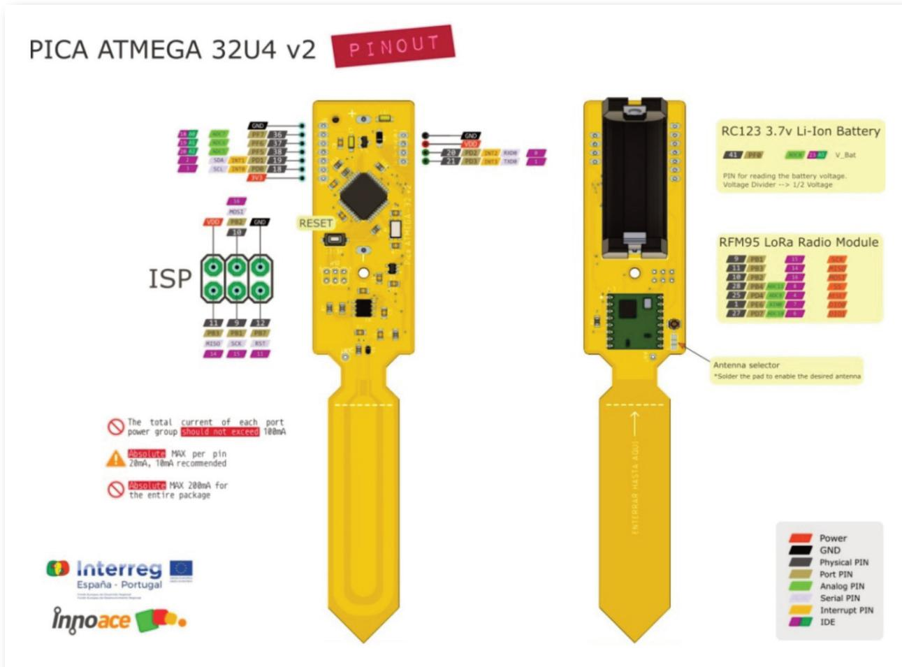
Figura 132 - PINOUT de la pica con especificaciones.
