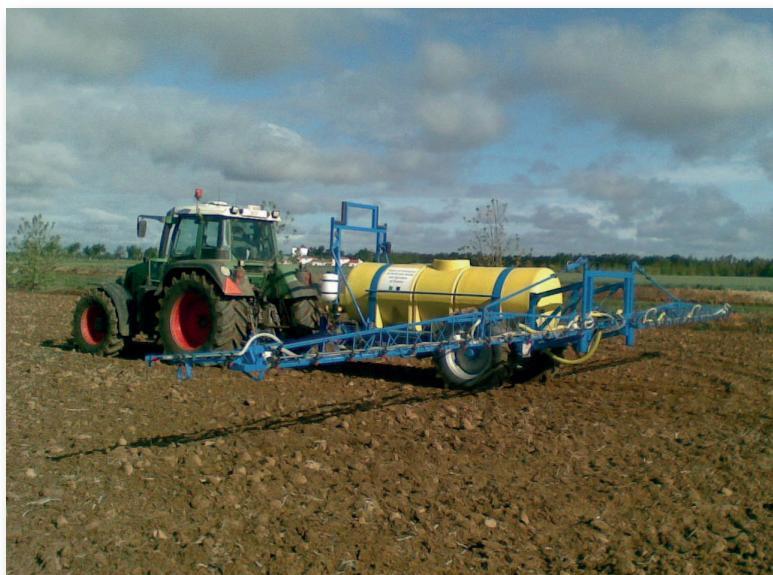
Figura 10 - Equipo de pulverización de dosificación variable.
