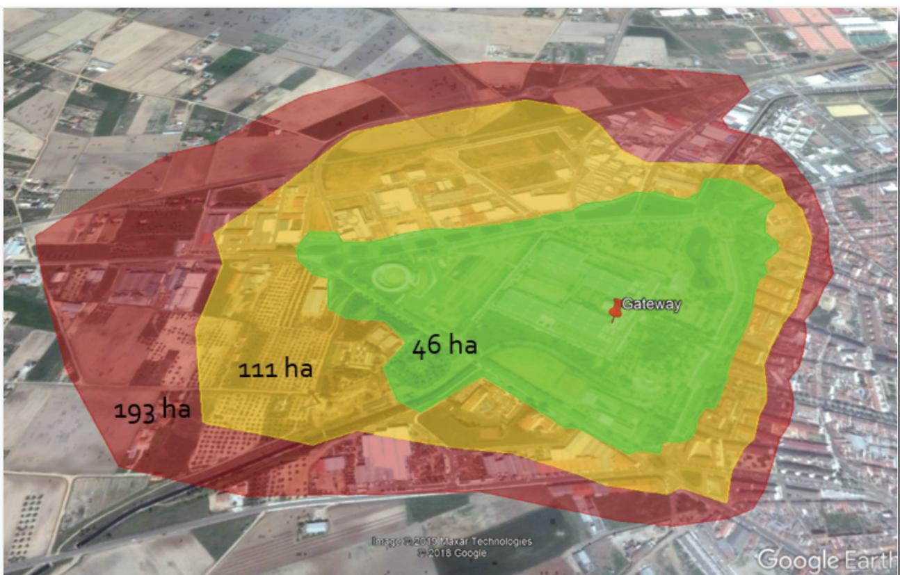
Figura 127 - Cobertura obtenida con la antena desplegada.
