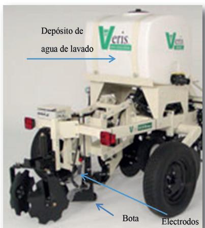
Figura 5 - Equipo de muestreo de pH.
