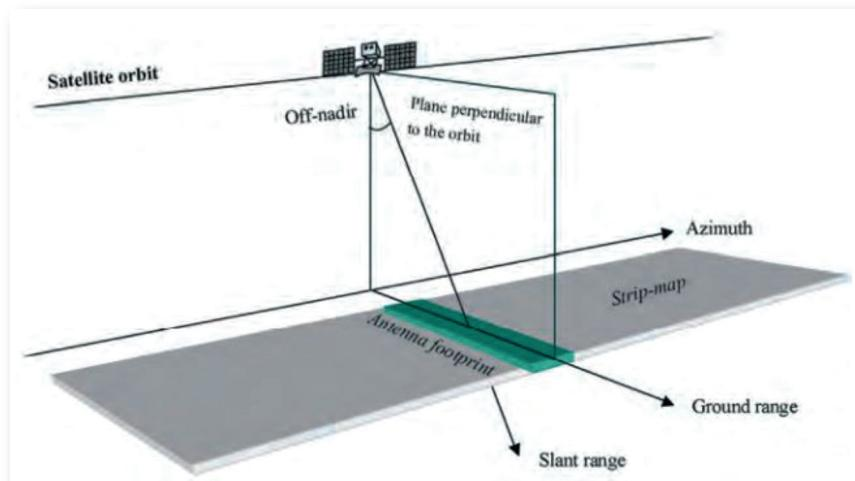
Figura 19 - Sistema SAR instalado en un satélite. Fuente: Rocca, F
