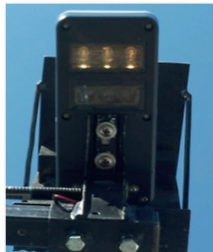
Figura 11 - Sensor de vegetación multiespectral activo.
