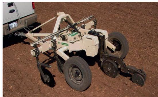
Figura 6 - Equipo de medición de M.O. VERIS Optic Mapper. Fuente: Veris Technologies, Inc.
